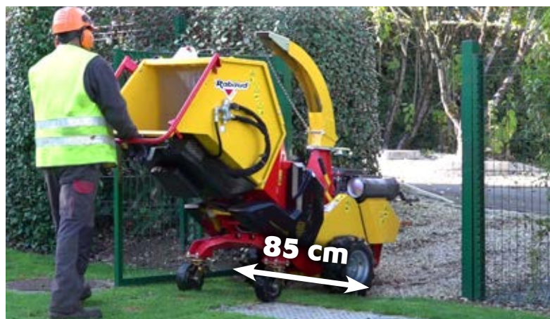
Broyeur compact pour un accès dans les zones les plus étroites
