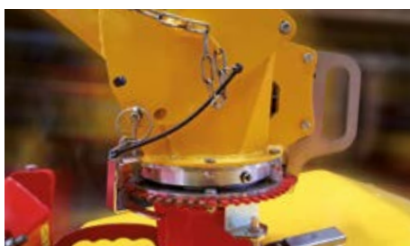
Goulotte d'évacuation montée sur couronne à billes facilement orientable sur 360° + capteur de sécurité zone d'alimentation
