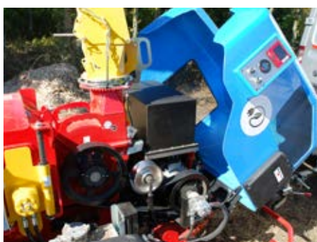
Capot en polyester pour un accès facile aux organes de la machine
