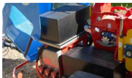
Bloc batteries 48 V, il n'est donc pas nécessaire d'être titulaire d'une habilitation électrique pour intervenir sur la machine
