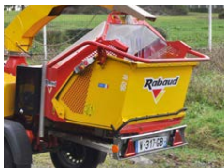
Trémie repliable pour plus de compacité au transport
